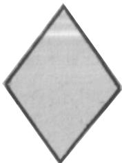
**Клеймо № 6** — ромбовидное (равносторонний ромб), длина каждой стороны 20 мм, высота ромба 33 мм. Погашение клейма производится крестообразным знаком по центру ромба.
